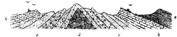
Fig. 4.ª—Corte del terreno desde Sigüenza á Bujarrabal.—Sigüenza.—Bujarrabal.—a. Margas irisadas.—b. Calizas del muschelkalk.—c. Areniscas abigarradas.—d. Rocas silurianas.
